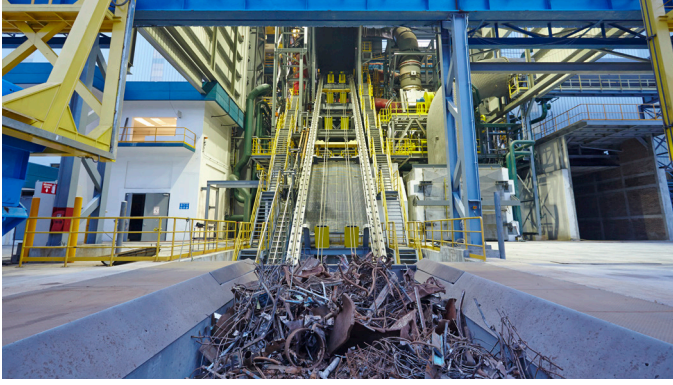
采用升降机的自动废钢装料系统
